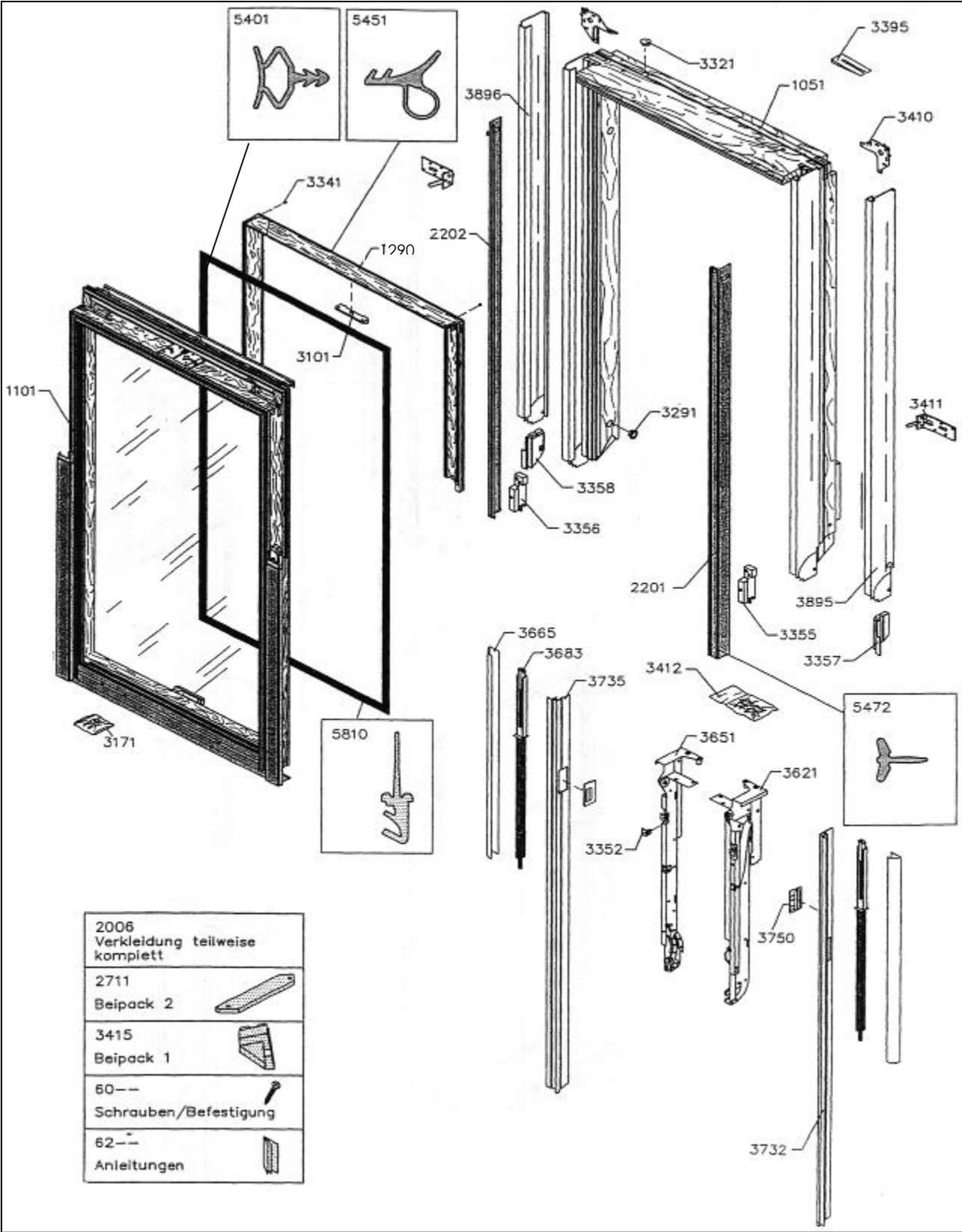
Obenelement GEL: Verglasung, Verglasungsdichtung, Beschläge, Abdeckbleche, Kleinteile
