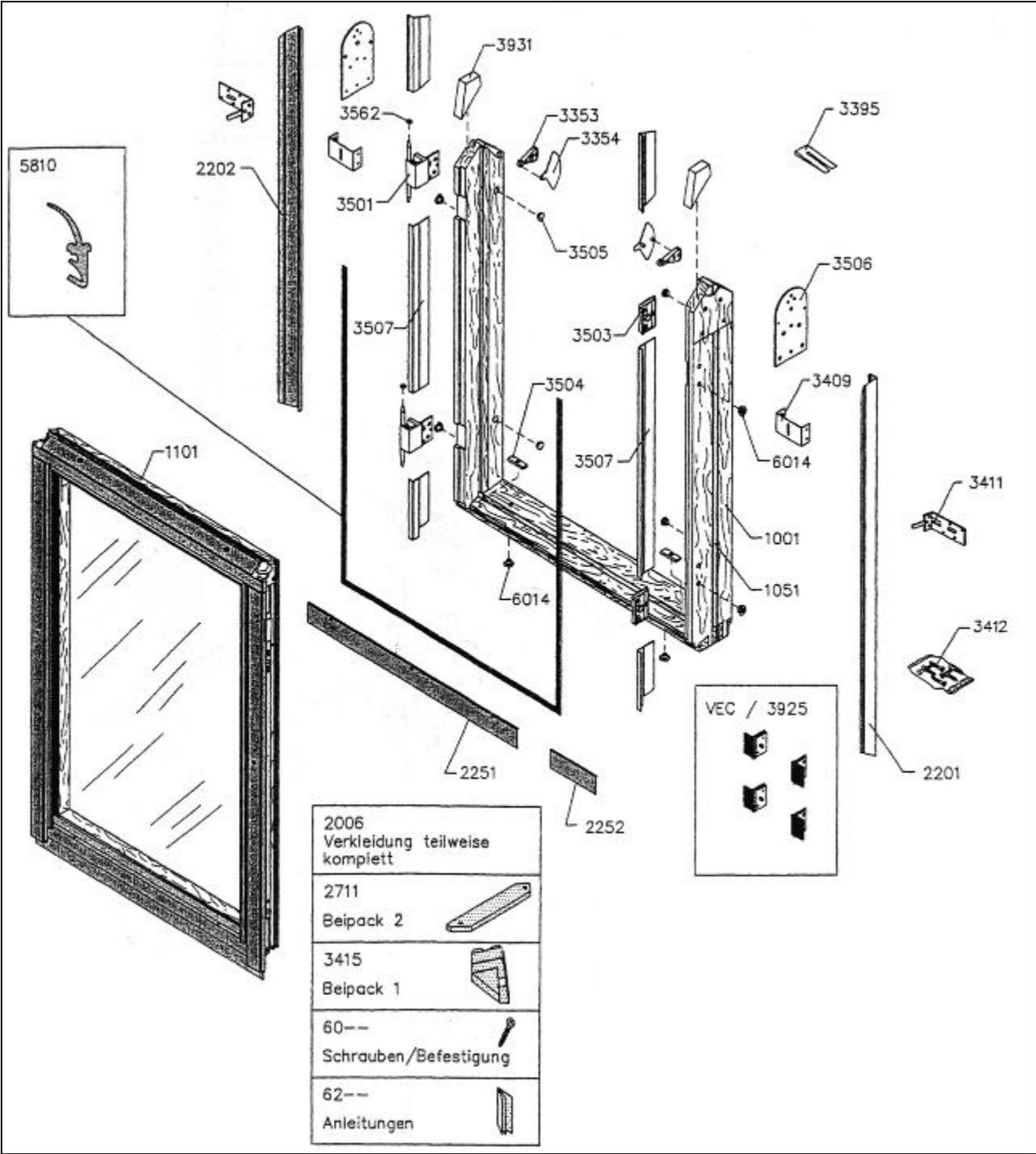
Untenelemente VEA/B/C: Flügel, Verglasung, Verglasungsdichtungen, Abdeckbleche, Verschluss-mechanismus
