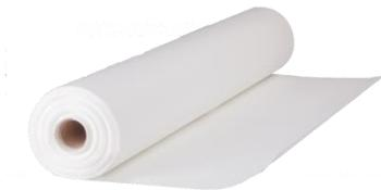
Für hohe Rissüberbrückung und Entkopplung insbesondere im Renovierungs- und Sanierungsbereich durch geringe Aufbaustärke. Für den Einsatz im Außenbereich in Verbindung mit SAKRET Schnellbauabdichtung SBA oder SAKRET Flexible Dichtungsschlämme FDS als wasserdichte, wasserdampfdiffusionsfähige Entkopplungsbahn. Gemäß ZDB-Merkblatt „Entkopplungssysteme“ für die Belastungsklassen EK-W, EK-G und EK-H einsetzbar.
