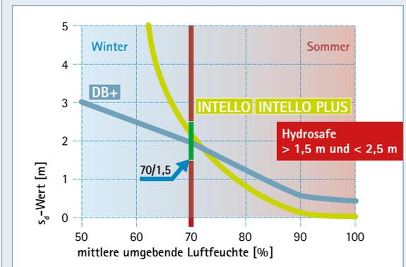
Der  $s_d$ -Wert der Bahnen stellt sich auf die unterschiedlichen Umgebungsfeuchten ein. Ein Hydrosafe-Wert zwischen 1,5 und 2,5 m schützt das Bauteil vor baubedingt erhöhter rel. Luftfeuchtigkeit. Gleichzeitig sichert er ein hohes Bauschadens-Freiheits-Potenzial von vollgedämmten Holzbaukonstruktionen.
