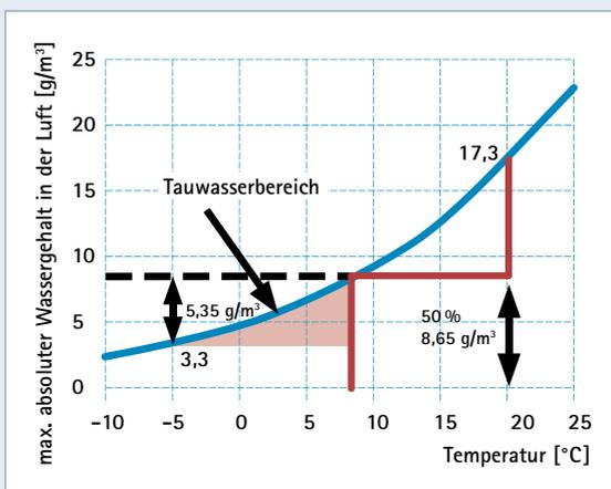
Bei einem Innenklima von 20 °C / 50 % rel. Luftfeuchte wird der Taupunkt bei 8,7 °C erreicht. Bei -5 °C fällt Kondensat von 5,35 g/m<sup>3</sup> Luft aus.
