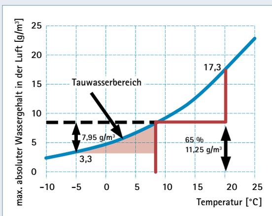
Bei erhöhter Raumluftfeuchtigkeit von 65 % rel. Luftfeuchte wird der Taupunkt schon bei 13,2 °C erreicht. Bei -5 °C fällt Kondensat von 7,95 g/m<sup>3</sup> Luft aus.
