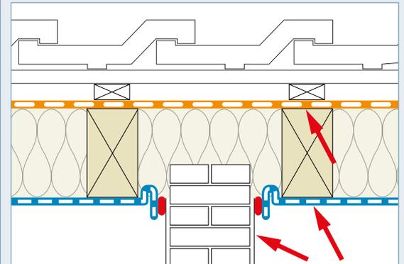
Luftdichte Konstruktion mit Dampfsperrfolie (PE) und luftdichter Putzschicht, außen Bitumendachbahn
