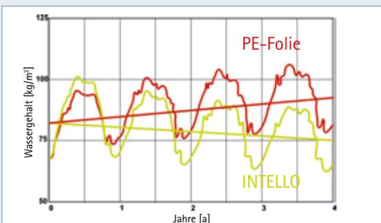
Ansteigender Feuchtegehalt im Bauteil mit PE-Folie  $s_d$ -Wert = 100 m konstant
