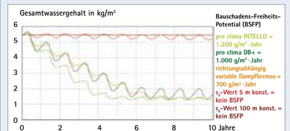
**19. BSFP mit INTELLO und richtungsabhängig variable Dampfbremse: verschiedene Dämmdicken**
