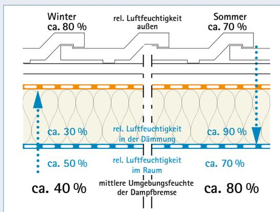
Darstellung der rel. Luftfeuchtigkeiten an der Dampfbremse abhängig von der Jahreszeit
