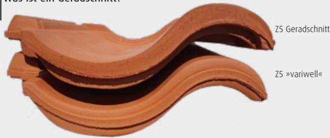
Beim Z5 Geradschnitt wird der Pressgrat im Traufbereich gerade abgeschnitten. Dadurch ähnelt der Ziegel optisch in der Eindeckung dem historischen Vorläufer, der Hohlpfanne, die aufgrund ihres stranggezogenen Produktionsverfahrens keinen Pressgrat aufweist.
