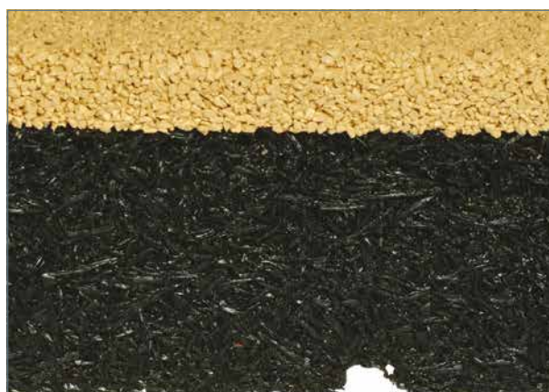
Der Querschnitt durch die Platte zeigt den zweischichtigen Aufbau mit der durchgefärbten EPDM-Schicht.
