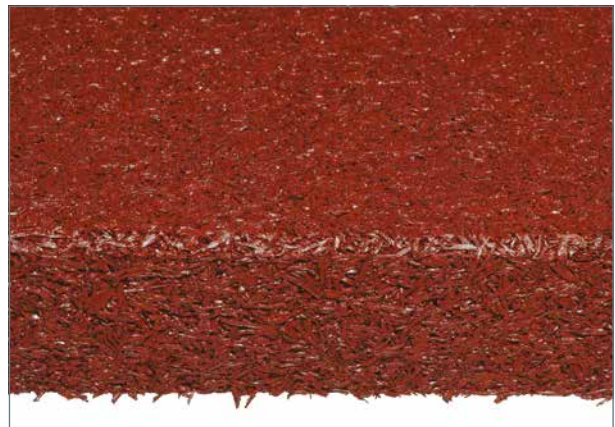
Der Querschnitt der Platte zeigt den homogenen Aufbau aus verdichtetem Material.
