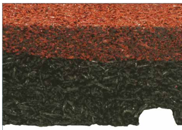
Der Querschnitt durch die Platte zeigt den zweischichtigen Aufbau.
