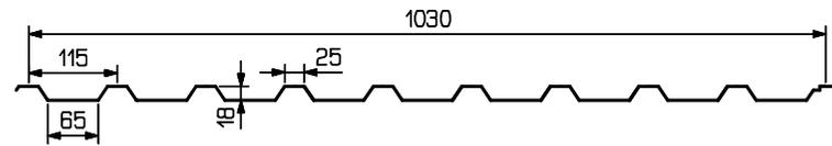
Zwischenauflegerbreite:  $b \geq 74$  mm
