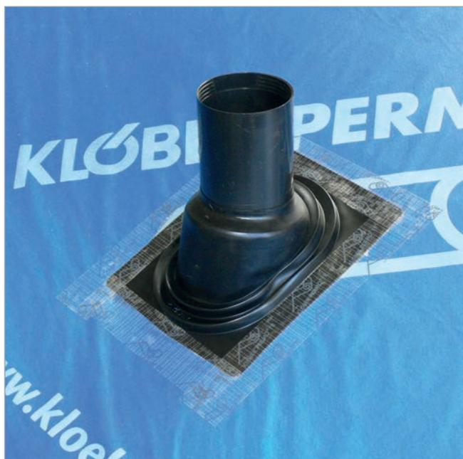
Die hochflexible Manschettenöffnung der Dunstrohrmanschette sitzt selbstdichtend am Rohrschaft. Zeitraubende Zuschnitte und Verklebungen am Detail entfallen. Selbst eckige Durchdringungen können sicher und dicht umschlossen werden. Bis 70° Dachneigung einsetzbar.
