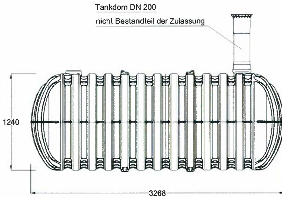
Abflusslose Sammelgrube aus Polyethylen (PE-LMD) für die Lagerung von häuslichem
