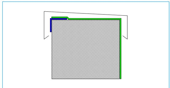
Alternativ kann die Anschlussbahn ca. 30 mm über den Gebäuderand geführt werden. Anschließend wird auf der Anschlussbahn ein Verbundblechwinkel (z. B. 3/7 cm) am äußeren Gebäuderand fachgerecht montiert (Befestigerabstand  $\leq 250$  mm). Der Übergang zwischen Verbundblechprofil und Anschlussbahn kann zusätzlich mit einem Bahnenstreifen überschweißt werden. Mauerabdeckprofil nach Herstellervorschriften montieren.
