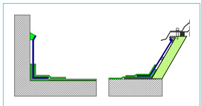
Alternativ kann die Flächenabdichtung auch direkt an ein Anschlussprofil aus Verbundblech geschweißt werden. Hierfür wird das Verbundblechprofil mit dem Horizontal-schenkel (mind. 40 mm) auf dem Untergrund aufgestellt und montiert. Die Flächenbahn wird mind. 40 mm in die Senkrechte hochgeführt und auf dem Horizontal-schenkel aufgeschweißt. Anschließend erfolgt die Wasser-dichte Verschweißung im vertikalen Bereich.
