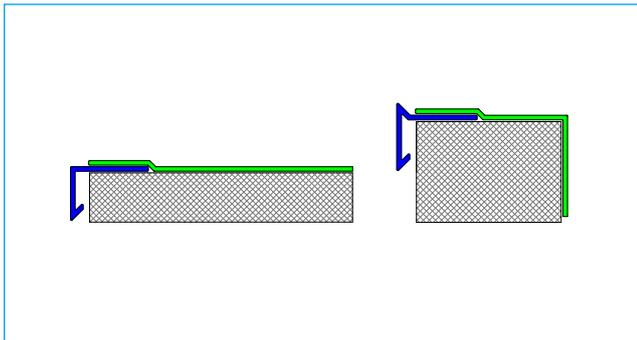
Alternativ kann die Flächenbahn bis zur Bauteilaußenkante geführt und mit dem Trauf- / Dachrandprofil aus Verbundblech befestigt werden (Befestigerabstand siehe Tabelle 2). Der Übergang vom Verbundblechprofil zur Flächenabdichtung wird dann mit einem separaten Bahnenstreifen überschweißt.
