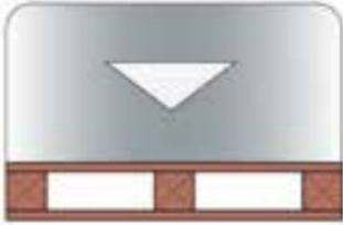
Palettengewicht je nach Bahntyp bis zu 1.200 kg. Auf dem Dach rollenweise vor Nässe geschützt zwischenlagern.
