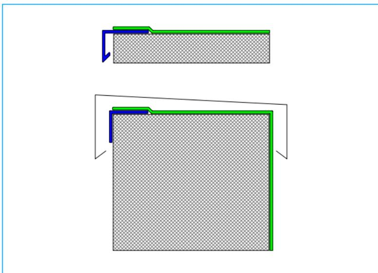
Alternativ kann die Flächenbahn bis zu Außenkante geführt und mit dem Trauf-/Dachrandprofil aus Verbundblech befestigt werden (Befestigerabstand siehe Tabelle 2). Der Übergang vom Verbundblech-Profil zur Flächenabdichtung wird dann mit einem separaten Bahnenstreifen überschweißt.
