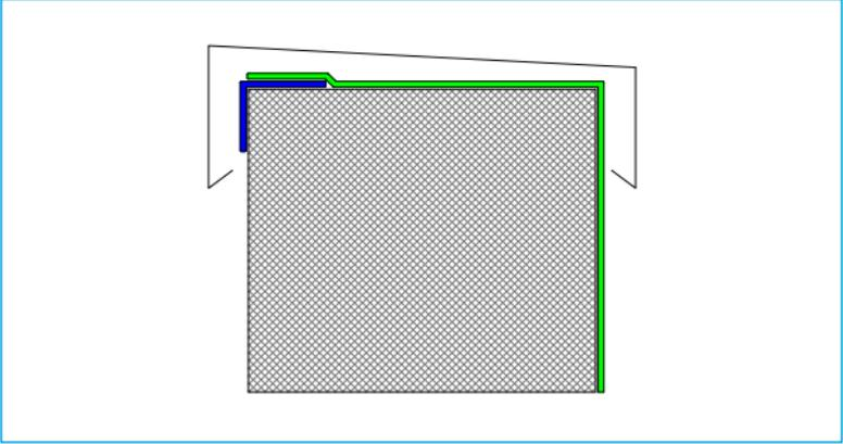
Alternativ kann die Anschlussbahn ca. 30 mm über den Gebäuderand geführt werden. Anschließend wird auf der Anschlussbahn ein Verbundblechwinkel (z. B. 30/70 mm) am äußeren Gebäuderand fachgerecht montiert (Befestigerabstand  $\leq 250$  mm). Der Übergang zwischen Verbundblechprofil und Anschlussbahn kann zusätzlich mit einem Bahnenstreifen überschweißt werden. Mauerabdeckprofil nach Herstellervorschriften montieren.
