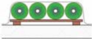
Bei Regen Rollen abdecken. Feuchte Bahnen können zu Problemen bei der Verschweißung führen.
