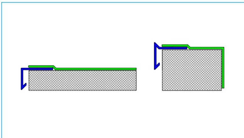
Alternativ kann die Flächenbahn bis zur Bauteilaußenkante geführt und mit dem Trauf- / Dachrandprofil aus Verbundblech befestigt werden (Befestigerabstand siehe Tabelle 2). Der Übergang vom Verbundblechprofil zur Flächenabdichtung wird dann mit einem separaten Bahnenstreifen überschweißt.
