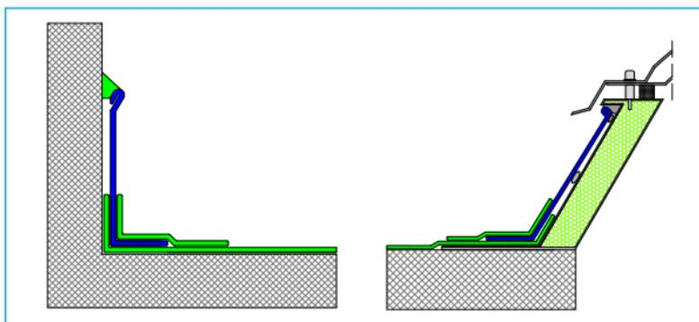
Alternativ kann die Flächenabdichtung auch direkt an ein Anschlussprofil aus Verbundblech geschweißt werden. Hierfür wird das Verbundblechprofil mit dem Horizontalschenkel (mind.
