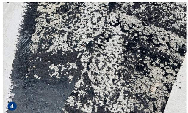
Bei unterseitiger Betonschlämme, empfehlen wir eine weitere Haftzugprüfung durchzuführen. Hier wird jedoch im Vorfeld die Probefläche abtragend vorbereitet, z.B. mit einem Winkelschleifer und der Verwendung einer Schrub- / Topfscheibe. Die Betonoberfläche muss so weit abgetragen werden, bis sich keine Betonschlämme mehr auf der Oberfläche befindet. Die Ergebnisse können anschließend miteinander verglichen werden. Wir empfehlen 3 Haftzugprüfungen pro 500 m<sup>2</sup> durchzuführen.
