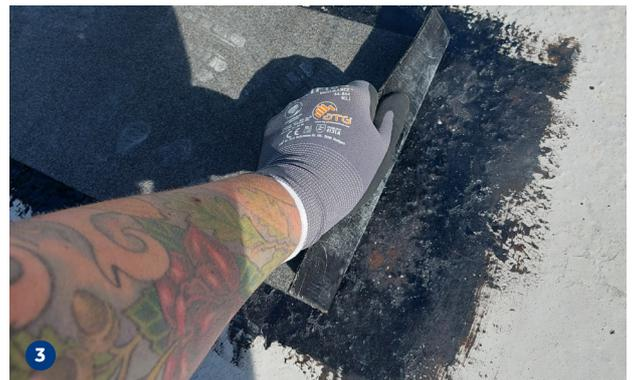
Eine gute Haftung zeigt sich dadurch, wenn beim Abziehen des Schweißbahnstreifens große Kraftaufwendung nötig ist, und/ oder Bitumenreste auf der vorbereiteten Betonfläche haften bleiben. Lässt sich der Schweißbahnstreifen leicht vom Untergrund abschälen, ist keine ausreichende Haftung gegeben. Häufig zeigen sich in einem solchen Fall auf der Unterseite der Bahn Rückstände von Zementschlämme.
