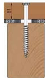
Vorbohren und Vorsenken mit dem RT Bohrsenker in einem Arbeitsgang.
