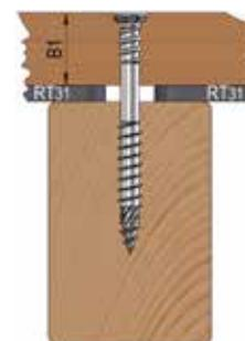
Vorboren und Vorsenken mit dem RT Bohrsenker in einem Arbeitsgang.
