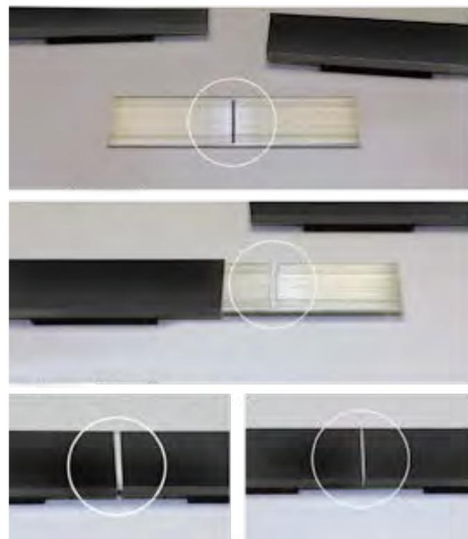
Die Längsverbinder verbinden die Schienen miteinander. Sie werden zur Hälfte in das Rechteckprofil der Schiene gesteckt. Auf die beiden mittigen Markierungen wird eine ca. 3 mm breite Klebstoffraupe aufgetragen (ferax® Kleben+Dichten). Die beiden Schienen zusammenschieben – fertig. Kleben und Versiegeln der Schnittstelle in einem Schritt. Kein Verschnitt – kein Abfall. Verschraubungen sind auch im Stoßbereich möglich.
