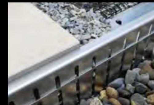
Das **variafix®** erlaubt die Befestigung des Belags inklusive dem Splittbett. Das Element ist in der Höhe verstellbar und kann so auch im Gefälle eingesetzt werden. Dank dem montierten Geogitter wird das **variafix®** durch das Eigengewicht des Belags dauerhaft und ohne Nägel fixiert. **variafix®** besteht aus einem Basiswinkel und einem angeschraubten und höhenverstellbaren Aufsetzelement. Das Element ist in zwei Höhen verfügbar.
