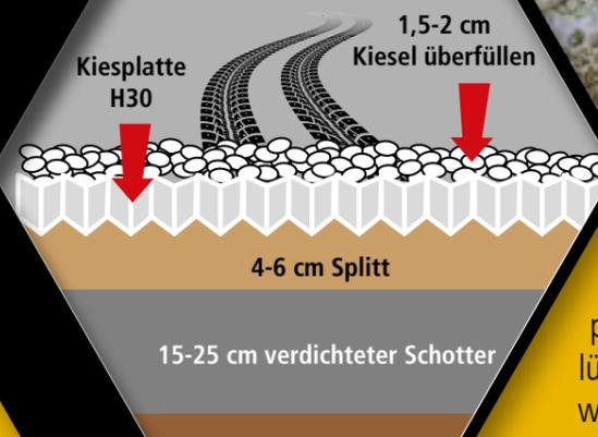
Diese **Kiesplatte** kann mit Hand- oder Stichsäge passgenau zugeschnitten und lückenlos an Hindernisse gelegt werden. Die Waben mit **Kiesel verfüllen**, mit einem **Rechen nivellieren** und dann noch eine Kieselsschicht auflegen. Die Matten sollen **immer vollständig mit Kiesel bedeckt** sein.
