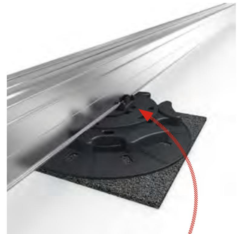
Wenn der Untergrund Unebenheiten aufweist, kann diese „Schieflage“ mit Porto-Stellfüßen ausgeglichen werden. Mit einem Klickadapter wird der Porto-Stellfuß sicher und ohne Werkzeug mit dem Aluprofil verbunden. Als rutschfeste Unterlage dient ein Terrassenpad in der Größe 200 x 200 mm.
