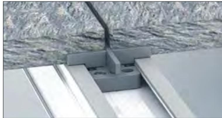
Montagetipp: Akustiktape rechts und links aufkleben, Plattenmaterial auflegen, System-Clip einklicken und festschrauben. So wird das Wandern der Platten verhindert. Das Fugenkreuz hat vorgefertigte Sollbruchstellen, so dass flächenüberstehende Seiten abgetrennt werden können.
