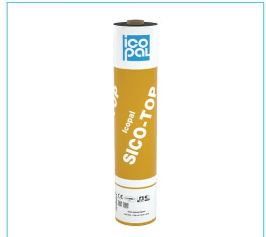
\* Doppelte BMI Icopal Sicherheitsnaht, d. h. Nahtbereich oben und unten aus gleichem Spezialbitumen, Nahtfolie ober- und unterseitig mit Cut-Lines und einem 2 cm breitem SK-Streifen plus 10 cm verschweißbarer Naht.
