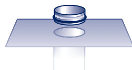
Anstauring Edelstahl mit EPDM-Ring, zum Einsatz des Dachgully-Systems als Notüberlauf-System für Ø 75/110/125/160 mm
