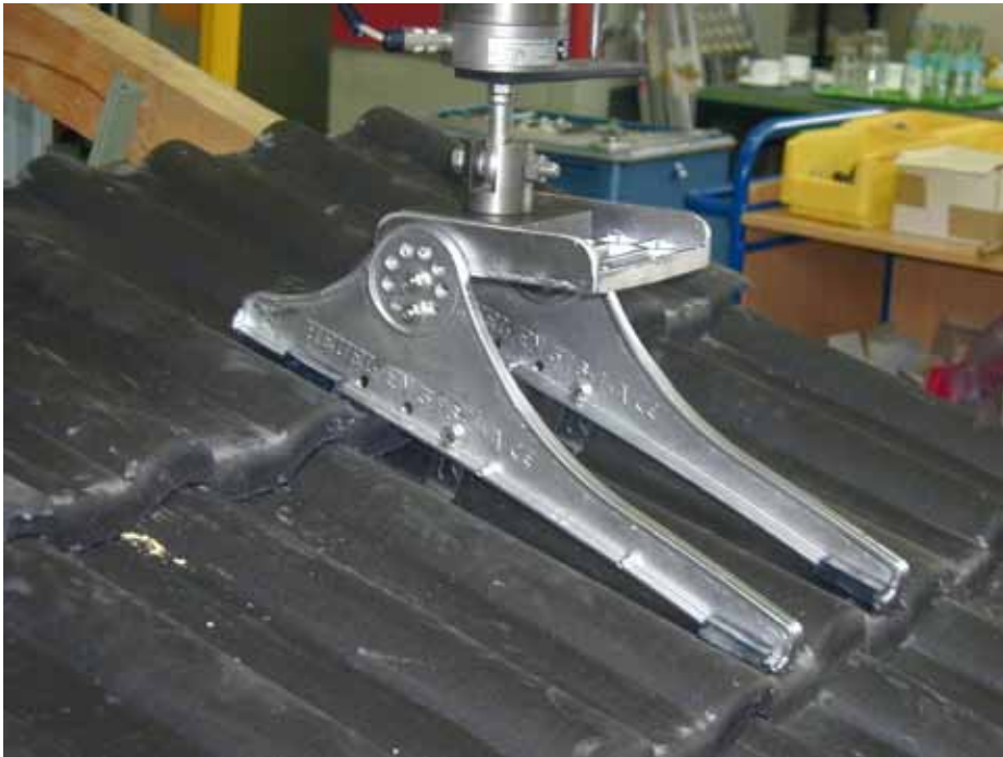
Bild 1: Prüfung des Steigtritts, Dachneigung 20°
