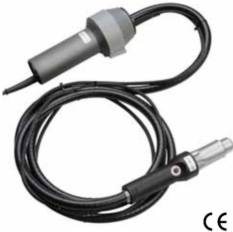
Der Vento-HB gehört der Familie der Vento-Line an und zeichnet sich durch seinen bürstenlosen Motor aus. Durch eine konsequente Optimierung der aktiven Kernelemente des Motors und den Einsatz einer modernen Einzelzahnwicklung wurde die Leistungsdichte im Vergleich zu herkömmlichen bürstenlosen Motoren deutlich gesteigert. Hierdurch erreicht das Gebläse Vento-HB eine starke Luftleistung von 450 Litern/Minute.
