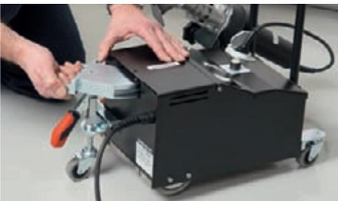
Der neue FORSTHOFF-DB Schweissautomat ist ein weiteres neues Modell der FORSTHOFF-Schweissautomatenpalette, in welchem das moderne Design und die Technologie der FORSTHOFF-P2 Generation übernommen wurde. Der FORSTHOFF-DB Schweissautomat ist ein sehr leistungsstarkes Gerät für das Aufbringen von 50 mm Gurtbändern.
