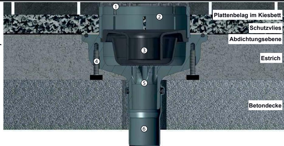
**Einbaubeispiel 2:** Profi-Balkon-Komplettablauf senkrecht in einer Betondecke mit Gefälleestrich eingebaut.
