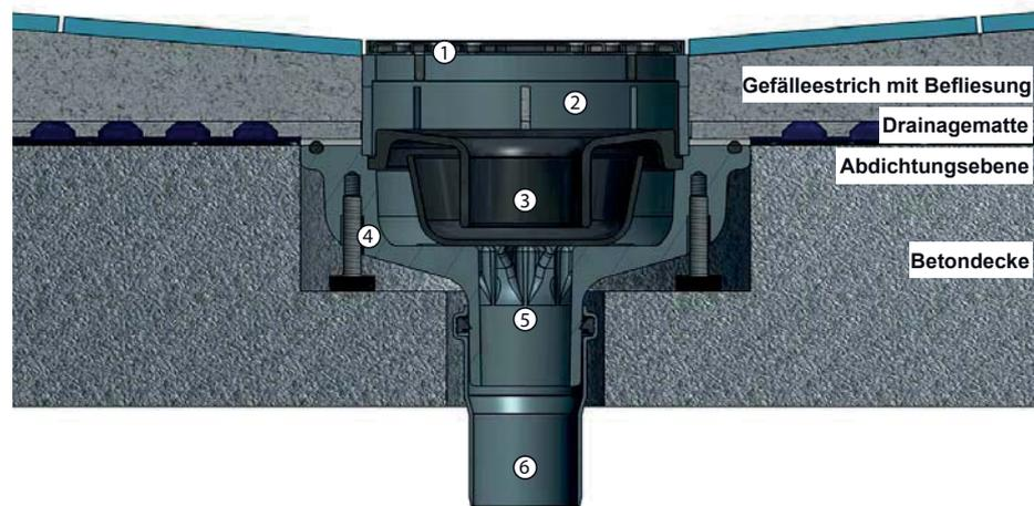
**Einbaubeispiel 3:** Profi-Balkon-Komplettablauf waagrecht in der Dämmung eines Warmdachs eingebaut.
