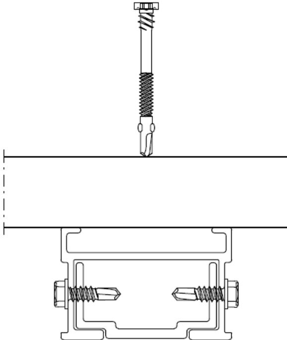
1. Die Profilflügelbohrschraube mittig über dem Alu-Profil auf der Diele ansetzen...
