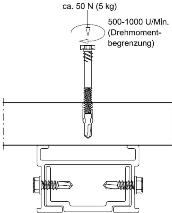
2. Die Profilflügelbohrschraube sollte beim Bohren mit mäßigem Druck (ca. 5 kg) und mittlerer Drehzahl (bis zu 1000 U/Min.) durch die Diele bohren...
