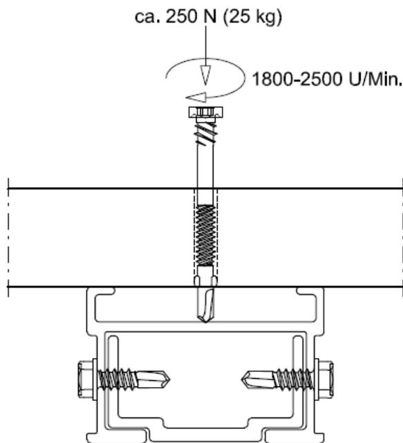
3. Trifft die Profilflügelbohrschraube auf den Befestigungssteg, sollte der Druck (ca. 25 kg) beim Bohren und die Drehzahl (auf bis zu 2500 U/Min.) erhöht werden...
