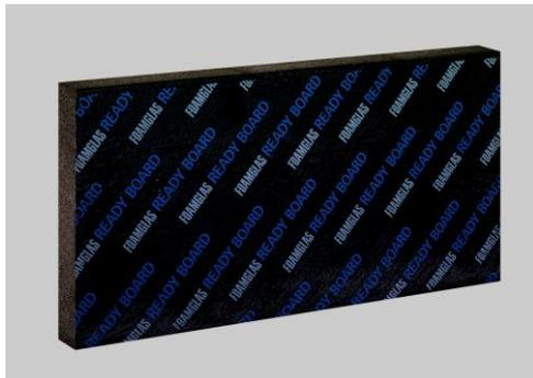
FOAMGLAS® READY BOARD T4+ bestehen aus verklebten FOAMGLAS® T4+ Platten. Oberseitig ist eine PE-Folienkaschierung und unterseitig ein weißes Spezialglasvlies aufgebracht. Die Oberseite ist zum Aufschweißen von Bitumenbahnen geeignet.
