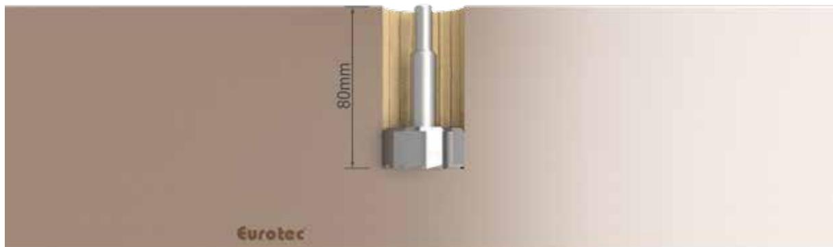
1.2. Bei einer Materialdicke  $> 80$  mm bis zu einer Tiefe von 80 mm bohren.
