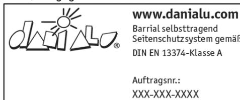
Der Barrial Materiallieferung liegt ein Prüfetikett mit der aktuellen Objekt-Nummer bei. Dieses ist nach Abschluss der Montage unbedingt seitlich an einer Geländerstütze gut sichtbar zu befestigen.
