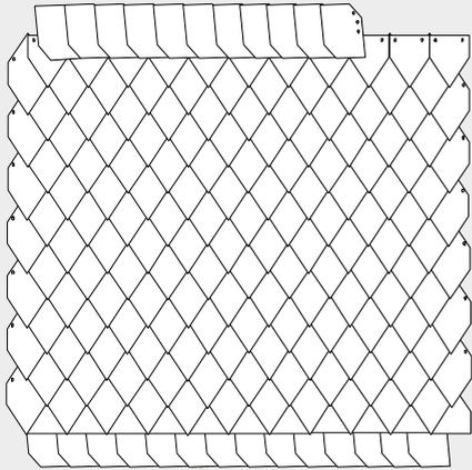
Die Spitzwinkeldeckung erfolgt im halben Verband mit Stoßfuge und mind. 1 cm Hängespitze. Die Mindestüberdeckung ist durch die Abschnittlänge plus 1 cm Hängespitze geregelt. Diese Deckung ist auf Vollschalung mit Vordeckung oder auf Lattung möglich.
