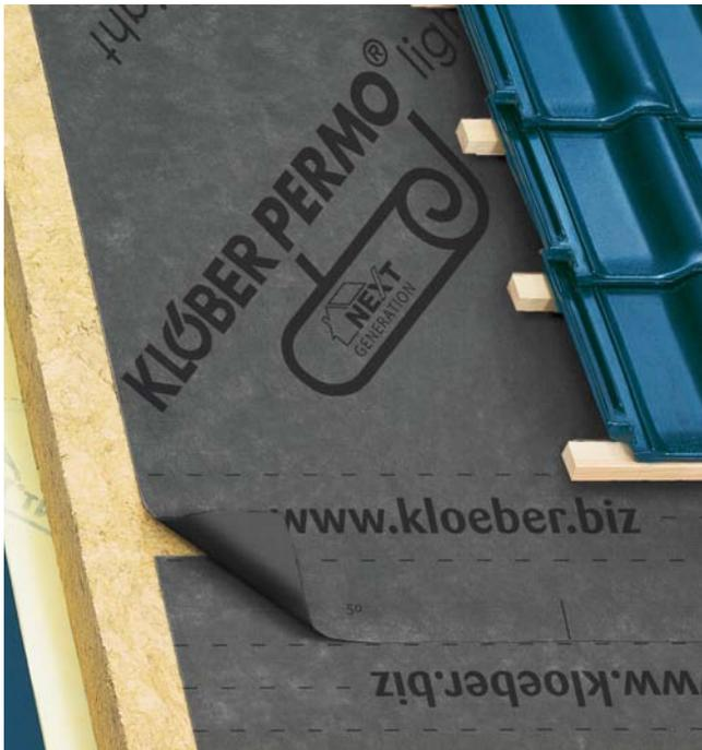
Zu Wohnzwecken genutzte Dachgeschosse oder vergleichbare Gebäude haben ein erhöhtes Anforderungsniveau. Zum Schutz dieses Wohnraumes empfiehlt Klöber die Ausführung als naht- und perforationsgesicherte Unterdeckung mit Permo® light SK<sup>2</sup>. Auf der Unterseite ist ein spezielles, stabiles Spinnvlies aufkaschiert, so dass die Verlegung auf Schalung ohne Probleme erfolgt. In Kombination mit den Original Klöber Klebe- und Dichtprodukten ist die Permo® light als Behelfsdeckung zugelassen.
