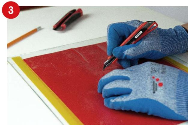
Der 30° Schneidewinkel bietet eine flexible Positionierung. Durch spezielle Hitze- und Säurebehandlung 3 x schärfer und 3 x längere Einsatzdauer als herkömmliche Klingen.
