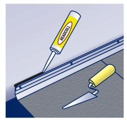
Bei der Anwendung als Fugenmasse mit einer feuchten Kelle abziehen, um Lufteinschlüsse zu vermeiden.
