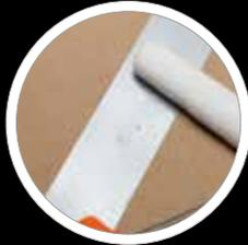
Kleinwalzen für ein makelloses Streichbild vor Gebrauch über ein Klebeband rollen, um so produktionsbedingte Flusen zu entfernen
