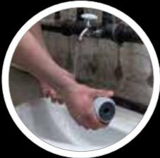
Vor Erstgebrauch produktionsbedingte Flusen unter fließendem Wasser durch Abstreifen entfernen
