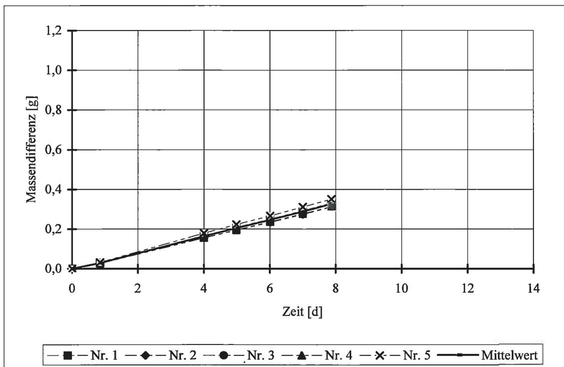
Bild 1: *Massendifferenz in Abhängigkeit der Zeit von VIA-FUGEN-DICHT 7*
