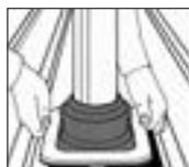
2. DEKTITE® an Profilblech anpassen und markieren.
