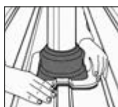
3. DEKTITE® formgenau an Profilblech anpassen.
