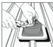
1. DEKTITE® an Rohr anpassen.
