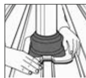
4. DEKTITE® formgenau an Profilblech anpassen.
