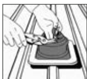
1. DEKTITE® an Rohr anpassen.
