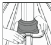
4. DEKTITE® formgenau an Profilblech anpassen.
