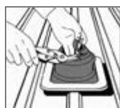
1. DEKTITE® an Rohr anpassen.
