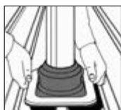
2. DEKTITE® an Profilblech anpassen und markieren.
