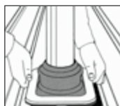
2. DEKTITE® an Profilblech anpassen und markieren.
