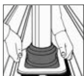
2. DEKTITE® an Profilblech anpassen und markieren.
