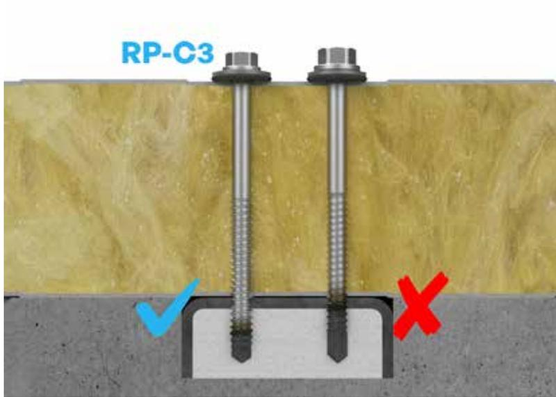
Konventionelle Bohrschrauben besitzen einen relativ langen Stahlpin. Bei der Fixierung auf niedrigen Hohlprofilen läuft man deshalb immer Gefahr im Stahlbereich zu befestigen.
