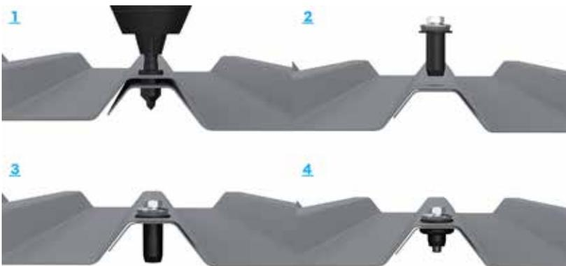
1.) Platten mit Stufenbohrer genau  $\varnothing 10$  mm vorbohren, bei ca. 800 – 1000 U/min. Montagefreundlich: Kein Durchrutschen des Stufenbohrers dank Anschlagring.
