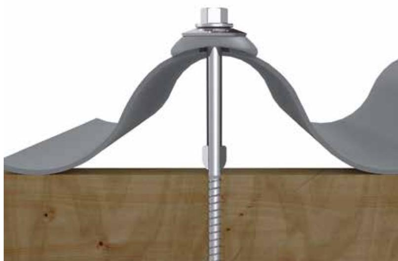
Die EPDM Glockendichtung passt sich der Plattenform exakt an und verschließt die Bohrung wasserundurchlässig.
