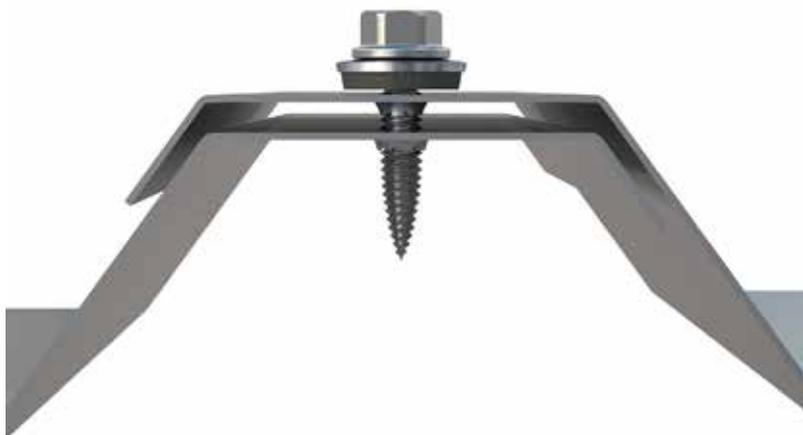
Bauteil 1 findet dabei zügig den Weg an die Dichtscheibe und presst sich an. Bei diesem Anpressvorgang rutscht Bauteil 1 in den gewindefreien Teil der Schraube.
