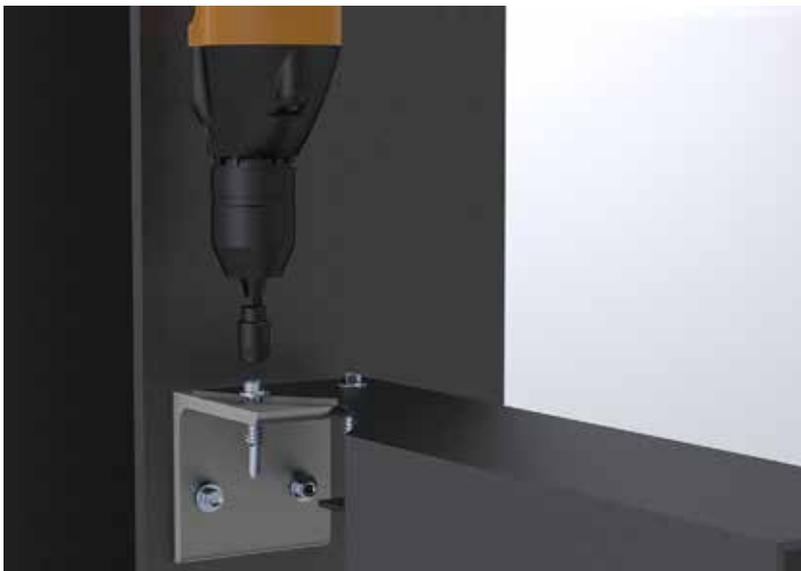
Vereinfachte Befestigung von Riegeln an Stahlkonstruktionen auch bei Bautoleranzen, da das zweite Bauteil (Anbauteil) im Schraubprozess punktgenau gebohrt wird.
