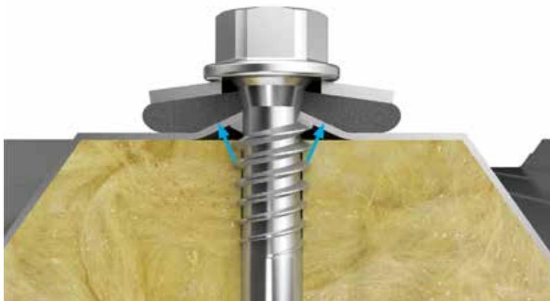
Dank der zwei auslaufenden Gewindegänge unter dem Kopf wird die Deckschale fest gegen die EPDM Dichtscheibe gepresst. Dadurch dauerhaft, zuverlässig dicht und auch bei erhöhter Schneelast und starken Temperaturschwankungen kein Absacken des Deckblechs möglich.
