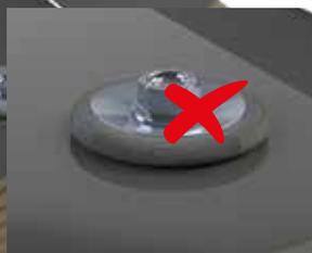
Zerstörte Unterlegscheibe und gequetschte EPDM Dichtung durch Einsatz von Schlagschrauber.
