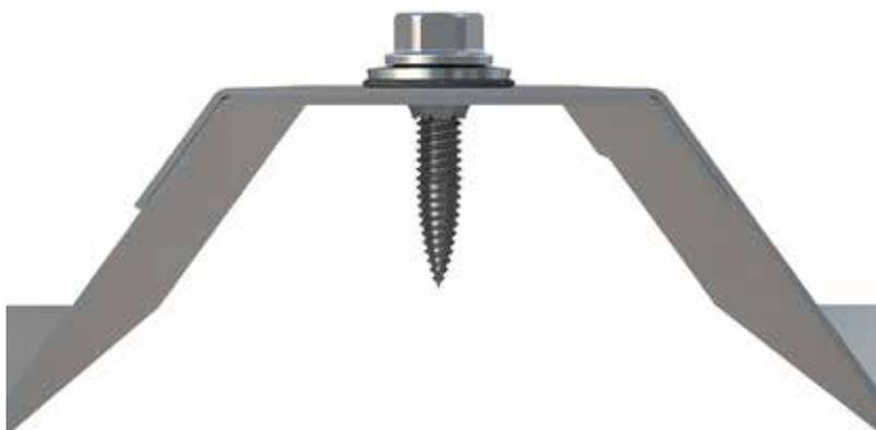
Gewindefreier Teil unter dem Schraubenkopf verhindert zudem, dass die Dichtscheibe durch einen zu hohen Anpressdruck beschädigt wird.
