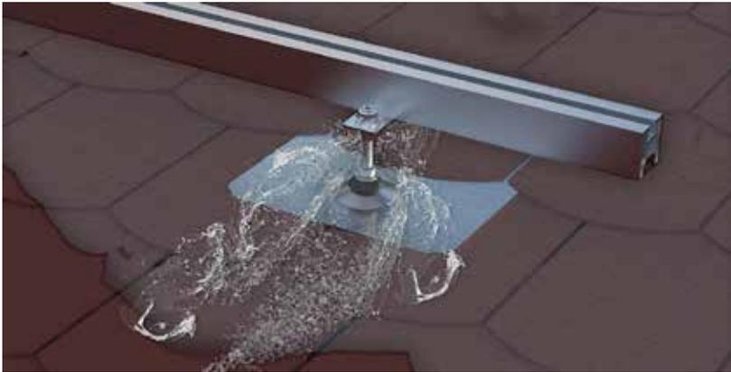
Regenwasserdicht, da anströmendes Wasser an der Wölbung des Formblechs abgeleitet und der Solarbefestiger dort gleichzeitig aus der wasserführenden Ebene gehoben wird
