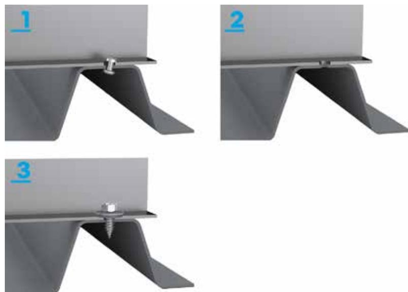
Zur Reparatur von losen Niet- und Schraubverbindungen
