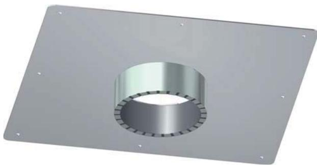
Brandschutzabdeckung für thermoplastische DN-Rohre in Massivdecken (gemäß DIN4102-11/ -A) mit Durchbrüchen bis ca. 300 mm Querschnitt/ Durchmesser und gemäß **Geberit bauaufsichtlicher Zulassung Nr. Z-19.17-1927!**
