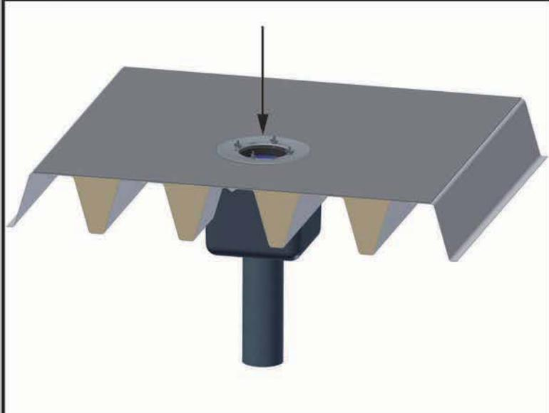
**6** Dämmung aufbringen und gemäß des gewählten Aufstockelements (Schritt 7) entsprechend aussparen/anformen..
