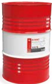
Lösemittelfreie, un stabile, kationische Bitumenemulsion mit einem Bindegehalt von ca. 60 %, für Oberflächenbehandlungen und Reparaturflickungen mit genormten Splitten zur Versiegelung von Asphaltstraßen, Qualität nach TL BE-StB 15
