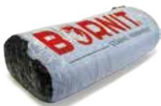
Bituminöser, heiß verarbeitbarer Dach- und Abdichtungskleber, ohne Füllstoffe, Erweichungspunkt über +100 °C, aufschmelzbar
