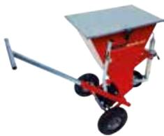
Der weiterentwickelte Abstreuwagen zum gleichmäßigen Absplitten der mit BORNIT®-Rissflex sanierten Risse oder mit Straßenbauemulsionen behandelte Kleinflächen. Streubreite bis 120 mm einstellbar, Füllvolumen ca. 50 ltr.. Stufenlos einstellbare Rüttelfunktion sorgt für gleichmäßigen Splittauftrag. Durch die senkrechte Abstreuerung entstehen keine „Wurfnester“. Als Abstreusplitt wird trockener 1/3er Edelsplitt empfohlen.
