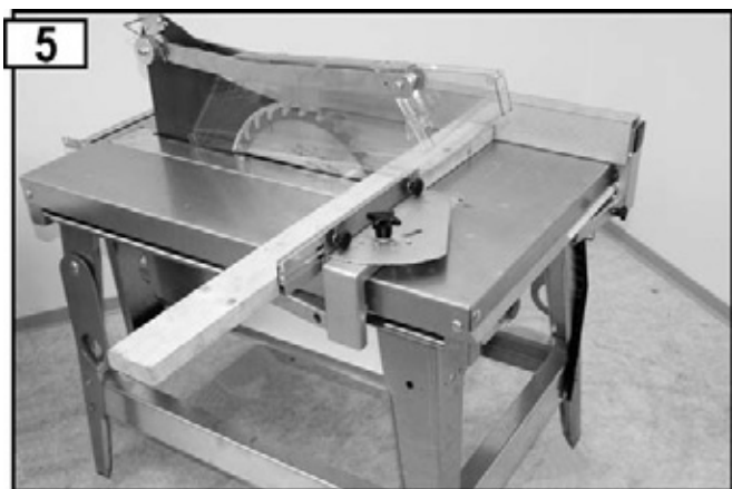
Opritorul paralel ca opritor pentru tăieri transversale
