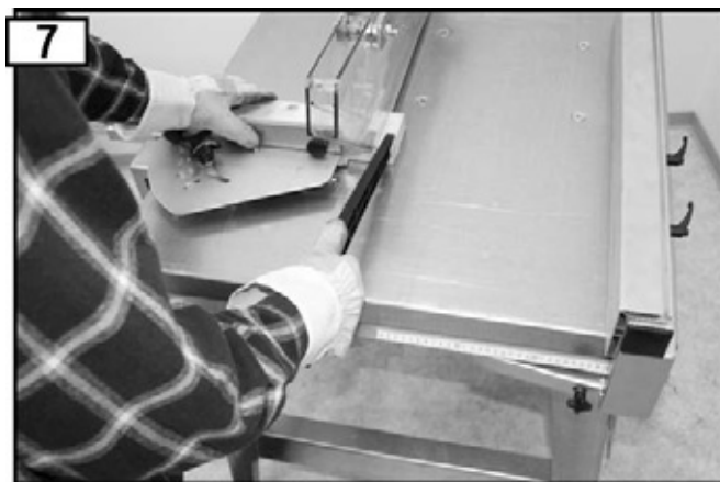
Utilizarea opritorului transversal mobil
