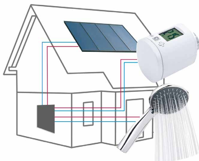
Thermokollektoren übertragen die Wärme über Wärmetauscher an das Wasser.
