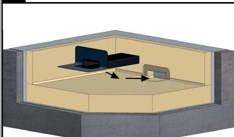
5. Dachabdichtungsbahn verlegen und Öffnung für den Einlaufbereich des Gullys passend ausschneiden. Dachabdichtungsbahn auf der Oberseite der Gullyanschlußmanschette verschweißen oder verkleben.
