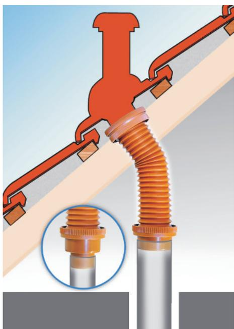
Quickflex flexibler Anschluss DN100
