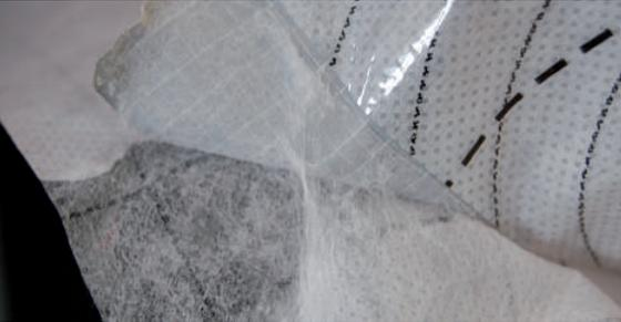
**Warum wird das Klebeband nicht auf der Vliesseite der Klimamembran verklebt?**
