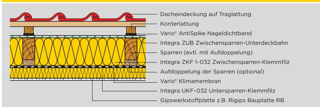
Die unterschiedlichen Komponenten des ISOVER Steildach-Dämmsystems werden aufeinander aufbauend verarbeitet.
