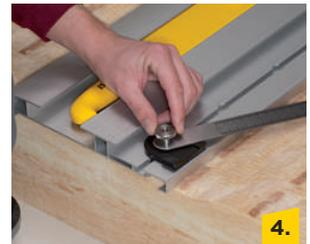
4. Rändelmuttern lösen und Lineale ausklappen.
